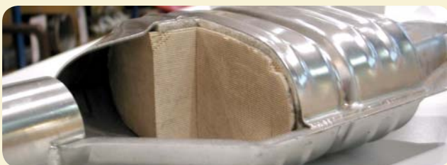
Katalysatorgehäuse aus 1.4507 (441), Pressteil.
