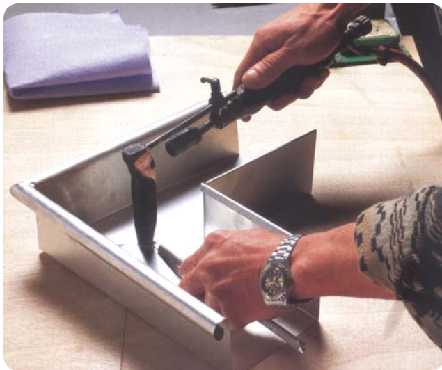
Weichlöten einer verzinneten Rinne aus 1.4520 (430Ti).
